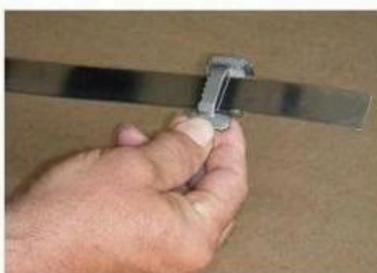
1. Corte una longitud de banda de acero inoxidable de acuerdo con el uso real, coloque la hebilla en un extremo de la banda y dele una longitud de unos 5 cm.
