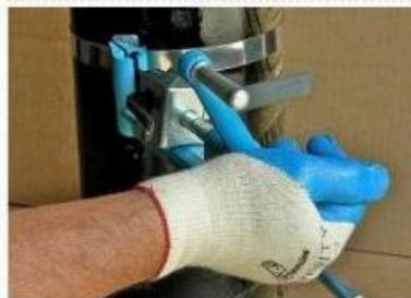
5. Cuando la banda esté apretada, doble todo el cinturón apretado hacia atrás y luego tire del mango de la hoja del cinturón para cortar la banda.
