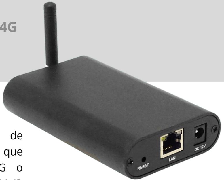
Yeastar TG es una línea de gateway VoIP GSM/3G/4G que conecta GSM, WCDMA 3G o redes LTE 4G a redes VoIP directamente. Es compatible con comunicación en dos sentidos: de GSM/3G/TG a VoIP o de VoIP a GSM/3G/4G.
