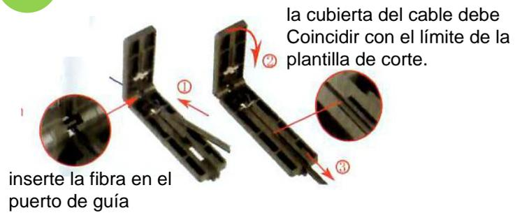
la cubierta del cable debe coincidir con el límite de la plantilla de corte.
