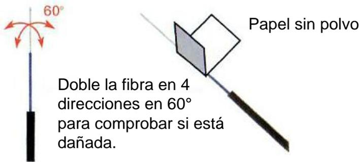
Doble la fibra en 4 direcciones en 60° para comprobar si está dañada.
