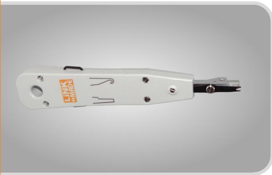
Punchadora de compresión e impacto, posee resorte interno que golpea los hilos para cables UTP, según un código de colores específicos sobre las cuchillas que tiene un módulo RJ45 hembra. Especial para la técnica de conectorizado IDC (conexión por desplazamiento de aislación), ya que las cuchillas metálicas del conector RJ45 hembra entran en contacto con el conductor de cobre de las hebras del cable UTP al ser este impactado (punchado) por la herramienta.
