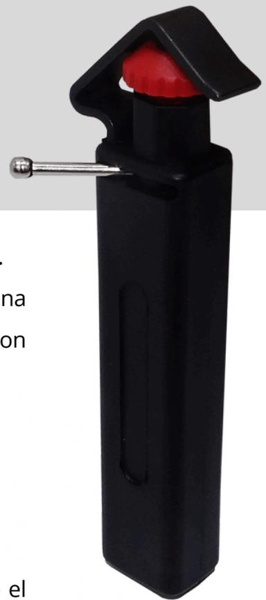
Esa herramienta se utiliza para pelar cables de fibra óptica. Cuenta con un ajuste de precisión para garantizar una profundidad de corte consistente y puede usarse con revestimientos que van desde 4.5 mm hasta 25 mm. Está diseñado para uso frecuente e intensivo.
