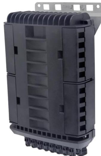
El FCTC-0416 puede contener hasta 16-24 suscriptores y 48 puntos de empalme como cierre. Se usa como un cierre de empalme y un punto de terminación para que el cable del alimentador se conecte con el cable de bajada en el sistema de red FTTx. Integra fibra empalme, división, distribución, almacenamiento y conexión de cable en una caja de protección sólida.
